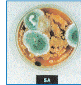
Mikrobiologische Abstriche ungenügend entwässerter Dieselproben
